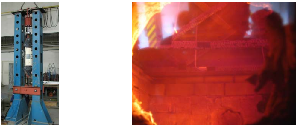
Obr.2 Zkoušky únosnosti spojů a požární odolnosti vazníků
